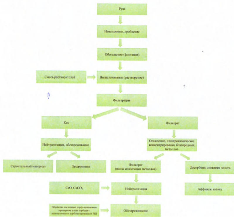
Рис. 19. Технологическая схема процесса извлечения благородных металлов из руд с низким содержанием золота, а также из производственных отходов, содержащих благородные металлы
